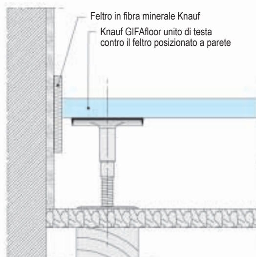
F181-V3 Posizionamento dei supporti su soffitti a travi di legno
